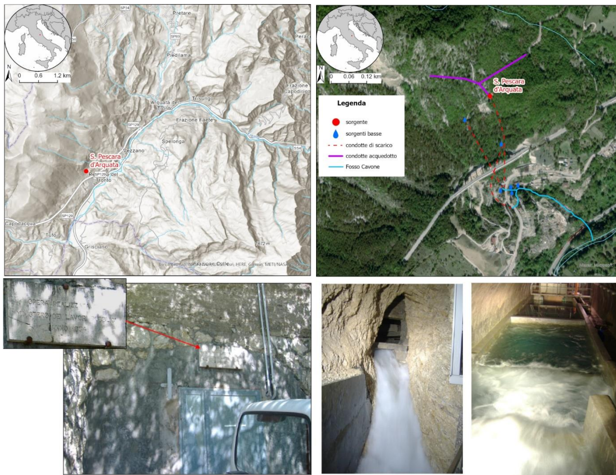
Figura 1 - La sorgente di Pescara d'Arquata: in alto (a sinistra e a destra) ubicazione dell'opera di captazione e caratteristiche dell'impianto; in basso a sinistra particolare dell'ingresso dell'opera di captazione, al centro e a destra particolare dell'interno dell'opera stessa.
