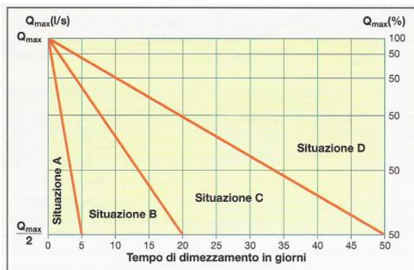
Fig.6.9 – Abaco per la determinazione della situazione di vulnerabilità in funzione del tempo di dimezzamento (da Civita, 2005)
