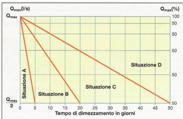
Fig.8.8 – Abaco per la determinazione della situazione di vulnerabilità in funzione del tempo di dimezzamento (da Civita, 2005)
